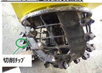
図1 T-A Dredgerの基本機構
