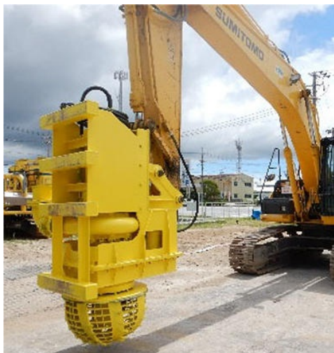
写真1 T-A Dredgerの建設機械への装着状況
