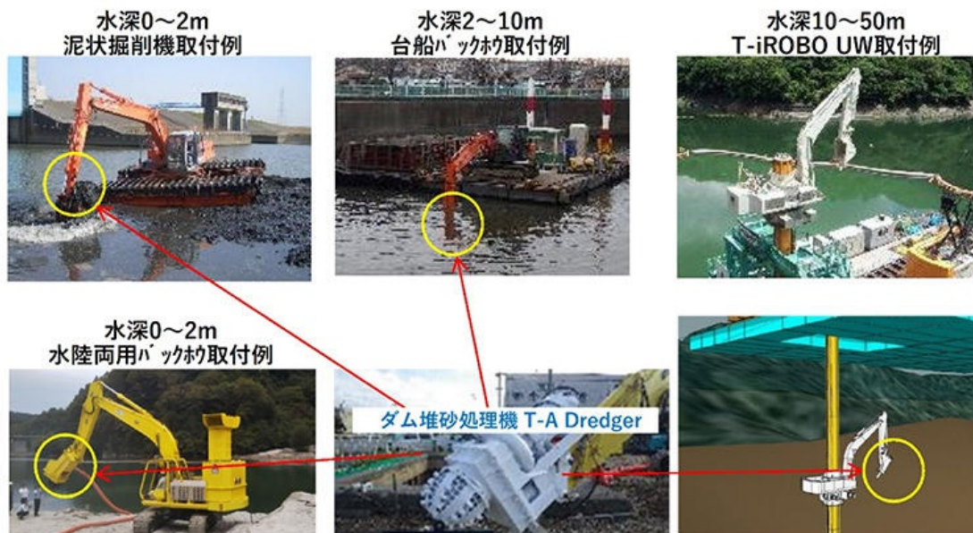
写真2 水深に応じた本装置の建設機械への装着例
