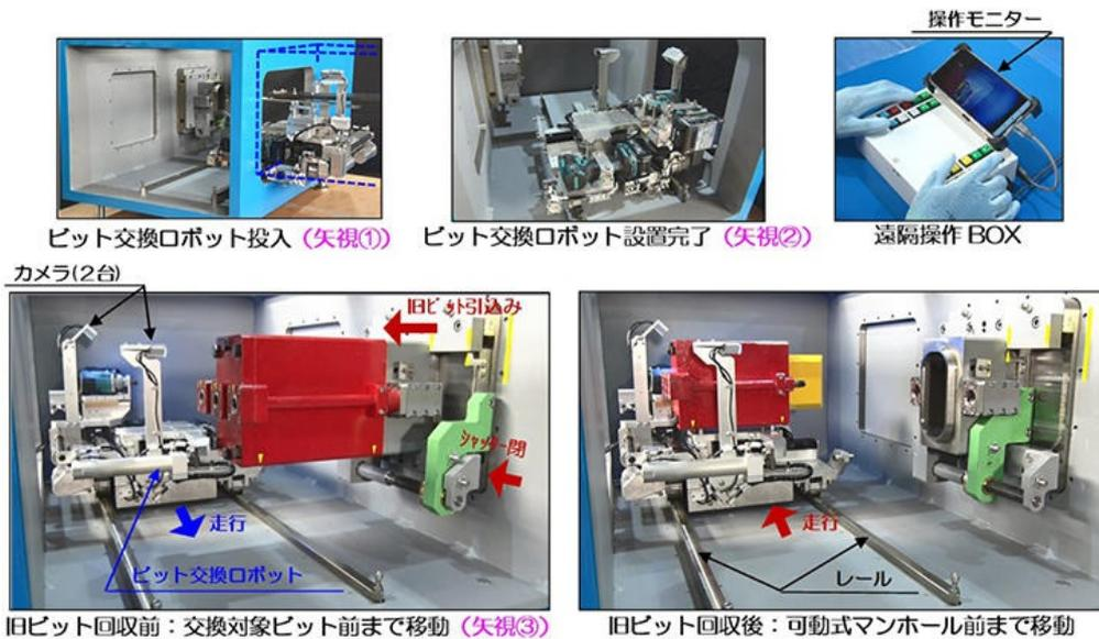
写真1 実証実験でのビット交換ロボットの作動状況
