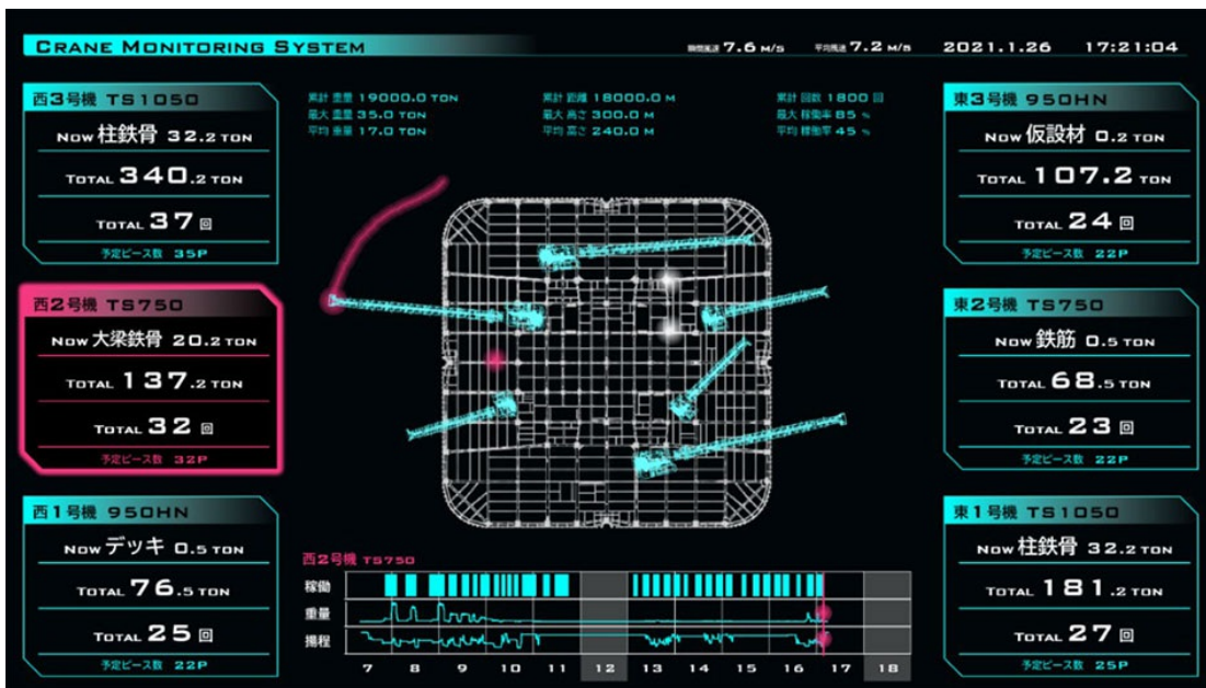
タワークレーンのリアルタイムモニタリング
