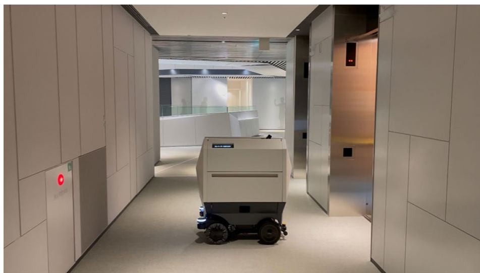
建物設備・ロボット連携基盤を介してエレベータや自動ドアとも連動
