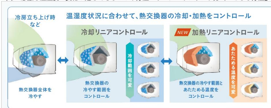
季節や暮らしのシーンで変化する室内の熱負荷に合わせて、除湿量を繊細に調整できる業界初※3の新機能を搭載しました。気温の高い夏場には除湿量を大幅に増加させ、梅雨や春先、秋口には冷媒流量をこまやかにコントロールして肌寒さを感じさせることなくしっかり除湿することができます。除湿量を従来機の1.5倍※3にアップさせるとともに、運転効率も10%※5向上させました。
