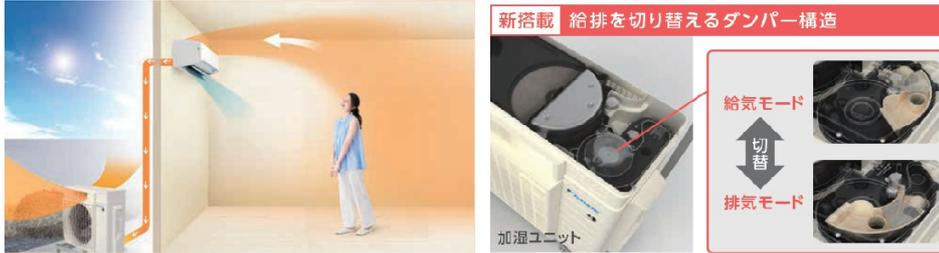
従来の『うるさらX』は、室外機の上に搭載した加湿換気ユニットと専用の換気ホースを使って屋外の空気を室内に送り込む給気換気機能が特長でした。本商品では新たにお部屋の空気を外に出す排気換気機能を搭載しました。加湿換気ユニット内部にはダンパー構造を設けており、お客様の生活シーンに合わせて給気と排気を切り替えることが可能です。夏場は室内の温度が屋外より高い場合に排気換気を行い、熱気の排出後には自動で給気換気に切り替える機能も搭載しました。冷暖房しながら換気することで室温を維持できるため、快適性と省エネ性が両立できます。
