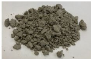
CO 2 を吸収・固定した処理土 (炭酸カルシウムと細骨材の混合物)
