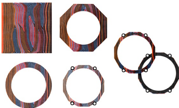
マルチカラーカーボンベゼルの製造過程
