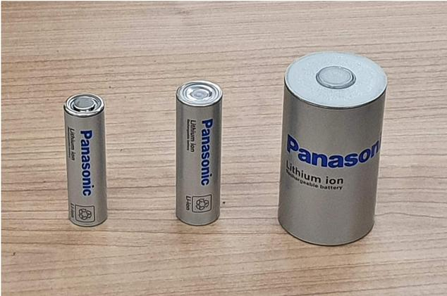
写真：高容量タイプの「4680」セル（写真右）
