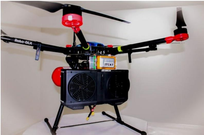
【ロボデックス社製 水素燃料電池ドローン】
