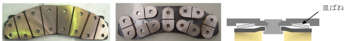
図1 ブレーキパッド（左：従来品、中央：開発品、右：開発品の断面模式図）
