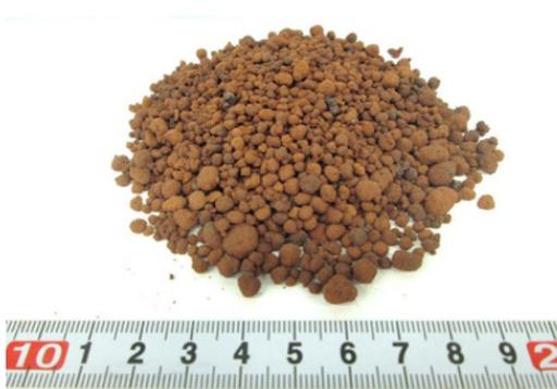
月の模擬砂から製造された多孔体
