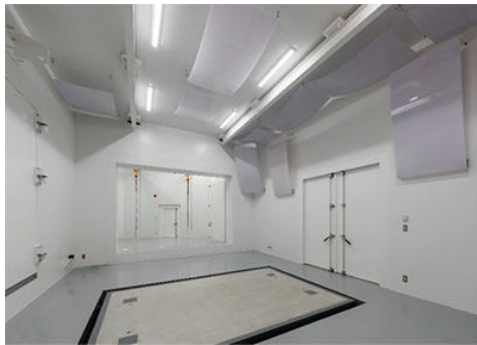
写真2 JIS遮音実験室（音源室）
