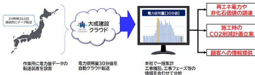
図2 電力使用量集計・分析システム「T-CARBON E-Site」概要図
