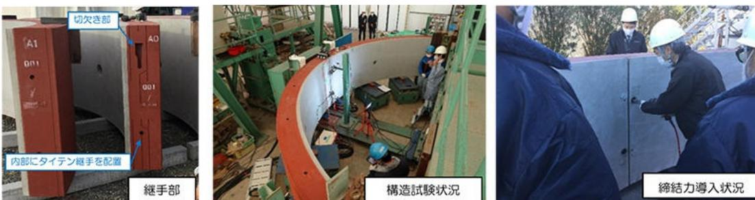
図3 タイテン継手を用いた実物大セグメント 各種試験状況
