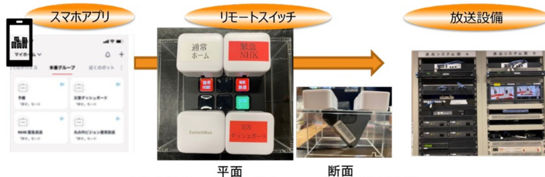
▲緊急切替器（リモートスイッチ）とスマホアプリによる遠隔操作の流れ
