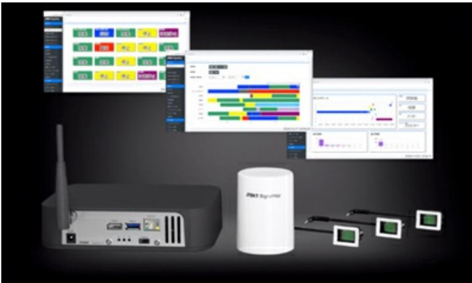
② 稼働監視システム：ポン付BOXを使った見える化の実現
