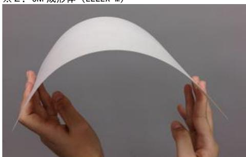
CNFとパルプ繊維を複合化したCNF高配合体の成形体は、軽量かつ高強度というCNFの特徴を生かしたシート形状の高性能材料であり、性能は汎用プラスチック材料を大きく上回る力学物性を示し、熱特性にも優れています。
