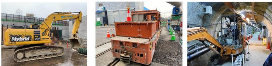
写真2 本システムを搭載した実証機の一例（左：油圧ショベル、中：蓄電池機関車、右：電動油圧ショベル）
