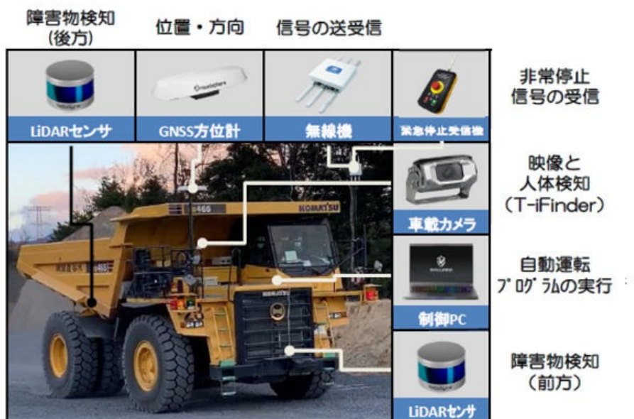
写真1 T-iROBO Rigid Dump外観と設置機器
