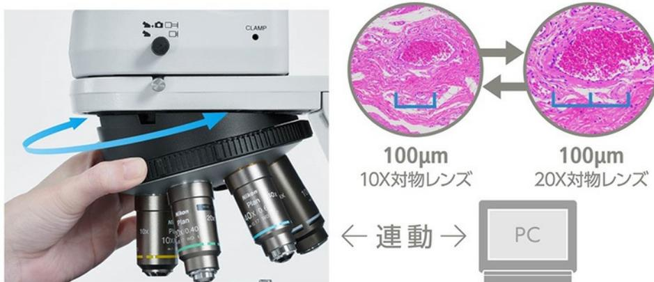
顕微鏡の倍率変更とパソコン上のスケールバーが連動するイメージ図
