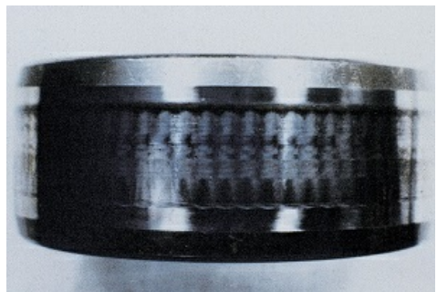
電食が進展した軸受の内輪
